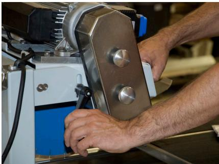
la conduite d'eau. Régler l'alimentation en eau avec le robinet de la machine. Les dispositifs antiprojection sont destinés à limiter le brouillard d'eau et à permettre le retour d'un maximum d'eau dans le réservoir.
